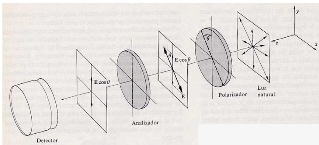
**Práctica 3:** observación de la luz transmitida por uno o dos polarizadores en función del ángulo de observación.
